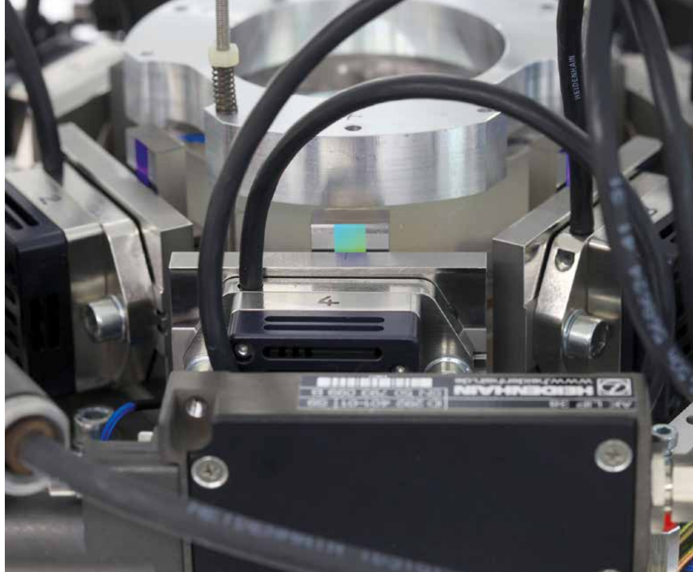
Filtro rodeado: los seis sistemas de medida de HEIDENHAIN se encuentran alrededor de ambas placas de vidrio.
