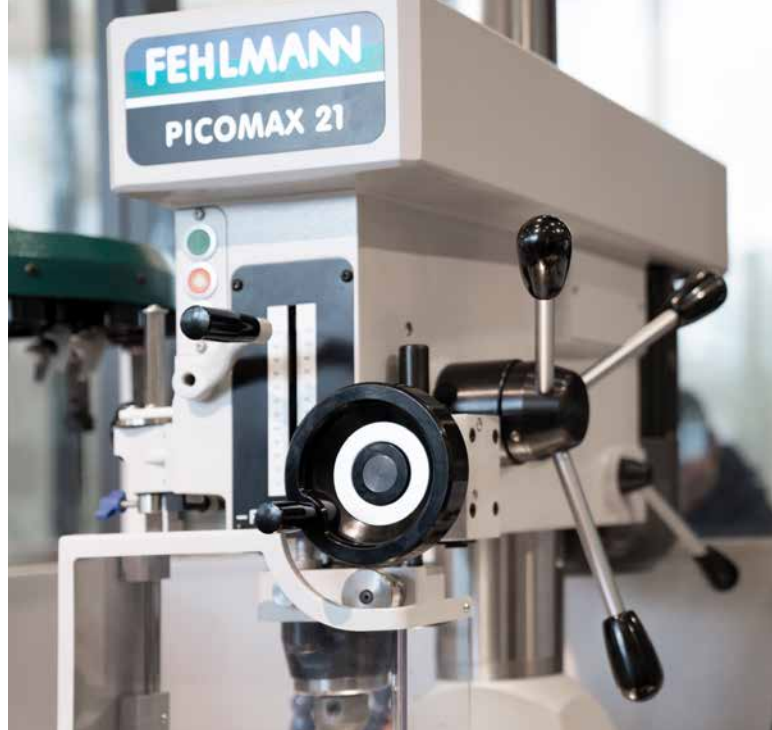
Máquina manual con mesa de posicionamiento y POSITIP 8000 ACTIVE: así sustituye la FEHLMANN PICOMAX 21-M a las máquinas CNC sencillas.
